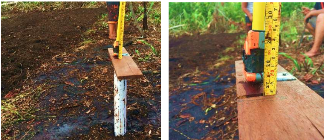
Gambar 3.8 Pengukuran Hidraulik Konduktivitas (K) Uji Lapangan Menggunakan Meteran Modifikasi
